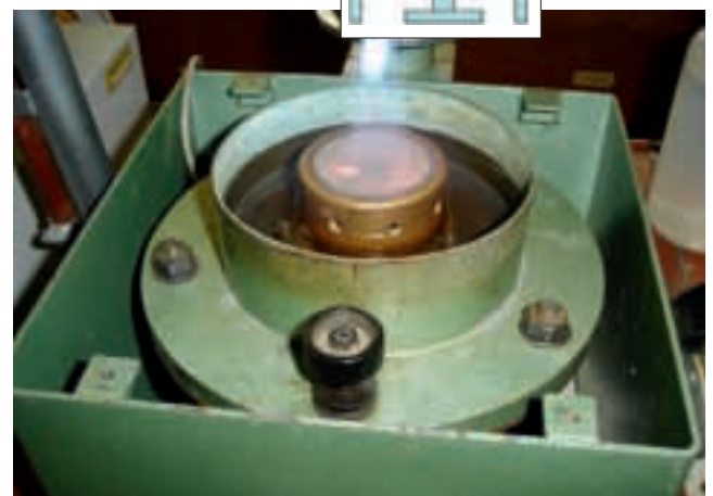
Abb. 7: Messung der Druckspannung einer Formsandschale während der Aufheizung. Das Fehlen von GKB erhöht in geringem Maße die Spannung, messbar anhand des Sensors unterhalb der Sandschale.
