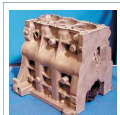
Bild 8: Kurbelgehäuse aus der Legierung AMC SC 1, hergestellt nach dem kunstharzgebundenem Kernpaket-Verfahren
