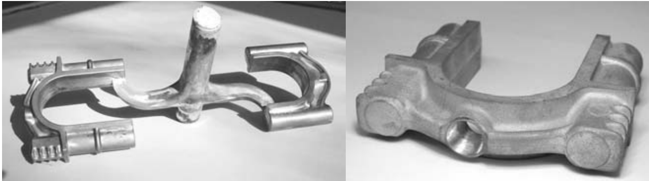
Bild 9: Nach dem Thixomolding-Verfahren gefertigtes Teil aus der Legierung AZ 91 mit oberer und unterer Lagerstuhlverstärkung; rechts: eingießbereiter einzelner oberer Lagerstuhl
