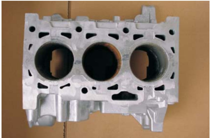
Bild 2: Closed-Deck-Zylinderkurbelgehäuse: Der Durchtritt des Kühlwassers vom Motorblock zum Zylinderkopf ist teilweise geschlossen.
