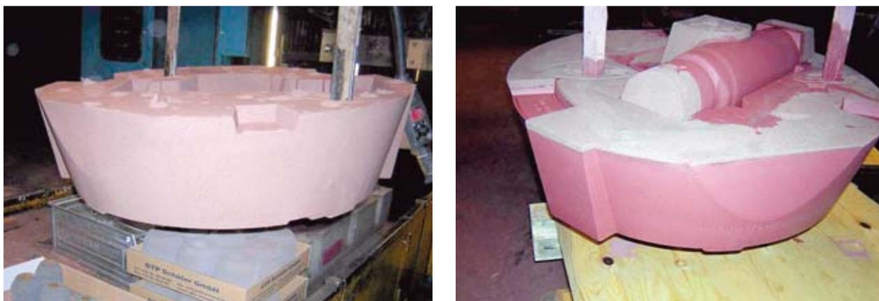
**Bild 5:** In der Componenta B.V. mit Antrapex gefertigter Cold-Box-Kern mit einem Gewicht von 166 kg
