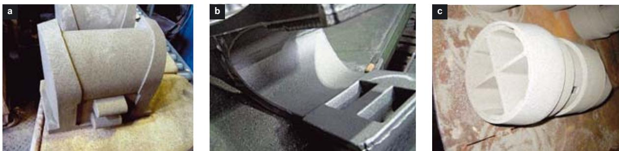
**Bild 4:** Beispiele der in der Walter Hundhausen GmbH mit Antrapex gefertigten Kerne: a) schlichtefreier Kern und b) damit gefertigtes Gussteil; c) Kern, bei dem die erforderliche Begasungszeit und die Aminmenge halbiert werden konnten
