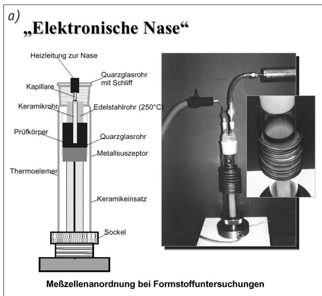
Bild 8. Meßzellenanordnung bei Formstoffuntersuchungen (a) und Auswertung (b)
